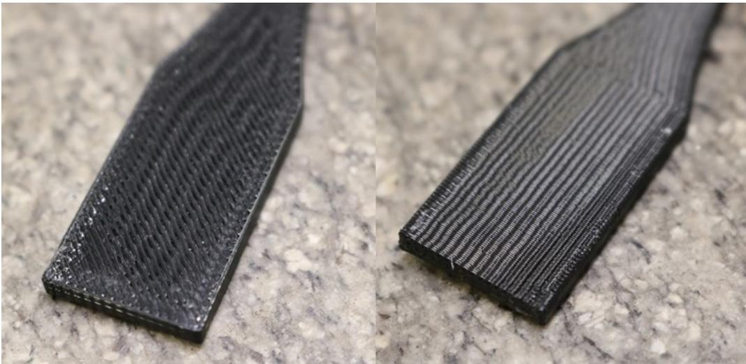
NOTA: À esquerda observa-se o corpo de prova com filamentos orientados paralelamente ao comprimento; à direita, com os filamentos orientados perpendicularmente ao comprimento do corpo de prova
